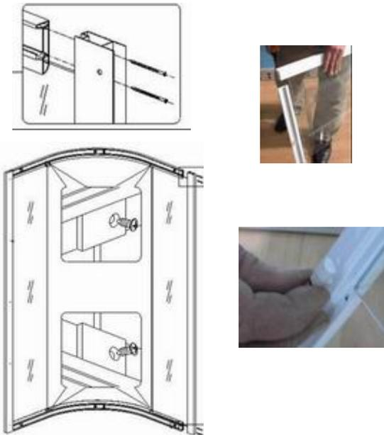
Unteres Rundbogenprofil und rechtes Seitenprofil mit Glasscheibe mit 2 Stück 3.8\*55 Schrauben verbinden.
