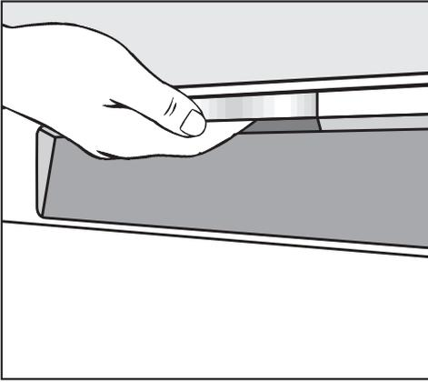
Die Tür wird am Programmende der Programme mit einer Trocknungsphase (siehe Kapitel "Programmübersicht") automatisch einen Spalt geöffnet, um die Trocknung zu verbessern.
