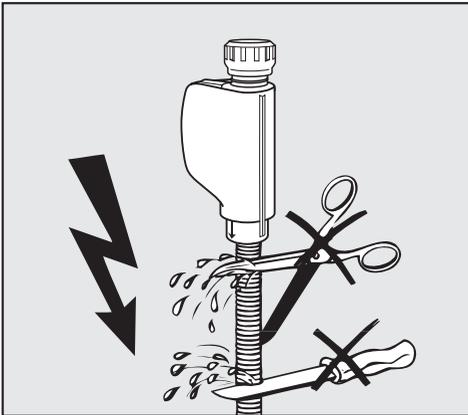
⚡ Der Zulaufschlauch darf **nicht** gekürzt oder beschädigt werden, weil sich darin spannungsführende Teile befinden (siehe Abb.).
