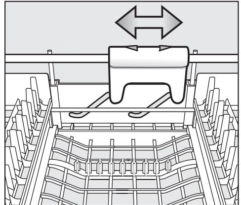
Um im mittleren Teil der Besteckschublade mehr Platz für größere Besteckteile zu bekommen, können Sie diesen Teil mit Hilfe der gelben Schieber in der Höhe verstellen.
