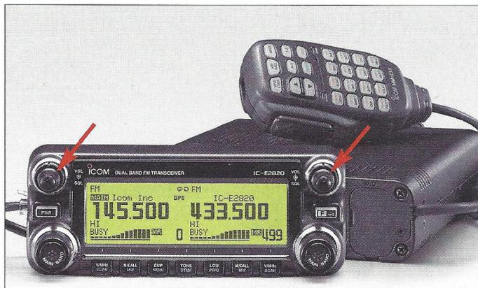
Das optional auch für D-STAR einsetzbare Mobilgerät IC-E2820 von Icom weist die typischen Merkmale eines *Twinbanders* auf: Es werden nicht nur zwei Bänder angezeigt, sondern beide Bänder lassen sich *simultan empfangen* – zu erkennen an *doppelt ausgeführten Lautstärke- und Squelch-Stellern* (Pfeile!).
