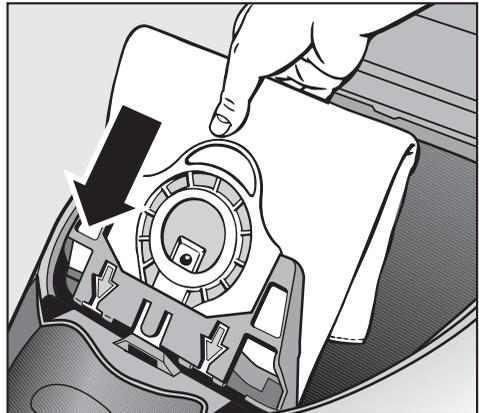
⚠ Eine Leerbetriebssperre verhindert das Schließen des Staubraumdeckels, wenn kein Staubbeutel eingesteckt ist. Wenden Sie keine Gewalt an.
