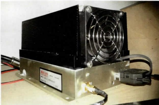
Bild 4: 50-W-Linear-Class-A PA 12 V/14 A für 2,4 GHz
