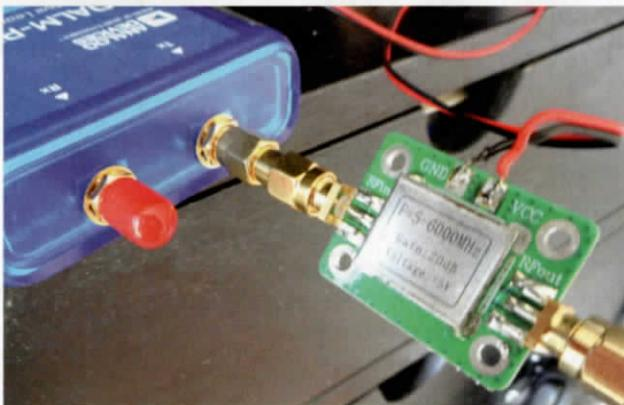
Bild 5: Der Adalm-Pluto mit nachgeschalteter Mini-PA
