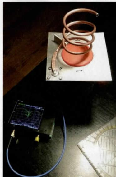
Bild 3: Dualfeed mit „Bullenaug“ und 3,5-Wdg.-Helix am nanoVNA
